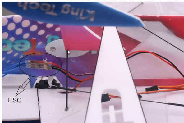
46. Install the ESC with velcro.
