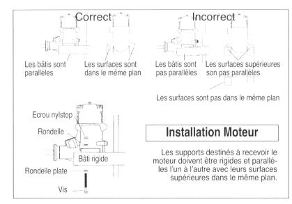
Positionner le moteur sur les bâtis à l'angle correct par rapport à l'axe du fuselage conformément aux instructions données sur le plan de l'avion.
