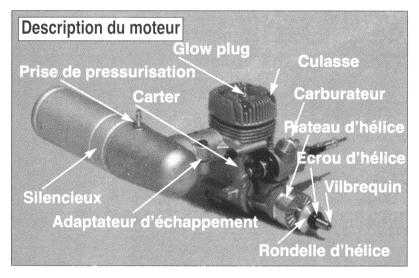
**Vilbrequin:** Le vilbrequin transforme le mouvement vertical du piston en mouvement totatif. L'hélice est montée sur la partie avant du vilbrequin. La partie du vilbrequin qui dépasse devant le plateau d'hélice est appelée axe d'hélice.
