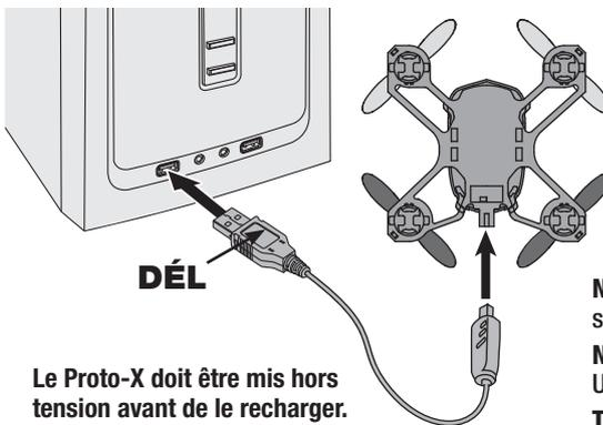
Le Proto-X doit être mis hors tension avant de le recharger.
