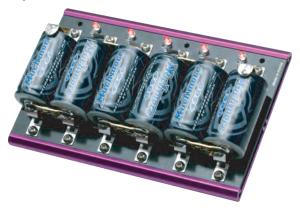
2. 正常的に連結されると、5個のLEDは点灯して放電を開始します。 放電が終了したセルのLEDは順次消灯し、すべてのLEDが消灯した 時点で放電終了となります。放電終了後は電池を外して保管用充電 を行ってください。
