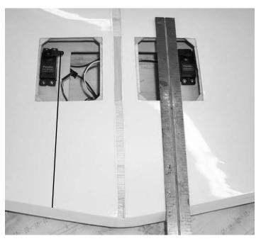
USE A STRAIGHT EDGE TO MARK A LINE FROM THE CENTER OF THE SERVO OUT PUT TO THE TRAILING EDGE, SQUARE TO THE SERVO.
