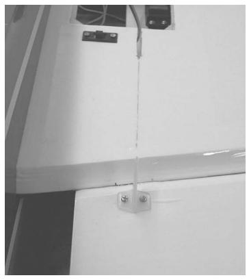
ALIGN THE AILERON CONTROL HORN USING THE LINE YOU DREW EARLIER FOR THE PUSHROD SLOT. MARK THE LOCATION OF THE HOLES AND DRILL TWO 5/64" HOLES. INSTALL THE HORN WITH TWO 2MMX20MM SCREWS AND THE NYLON PLATE ON TOP.
