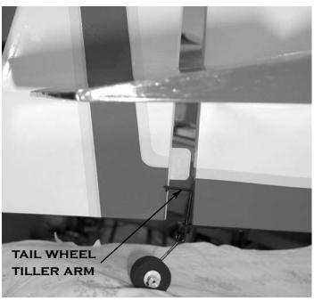
GO TO THE BOTTOM OF THE RUDDER AND MARK THE LOCATION OF THE TAIL WHEEL TILLER ARM.
