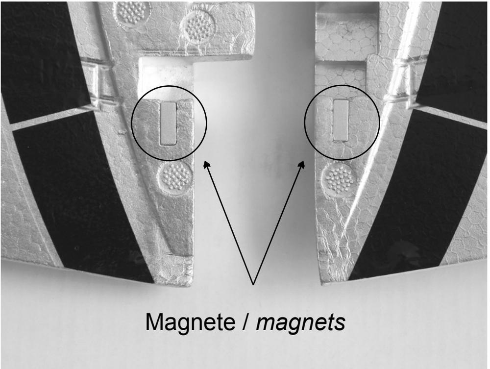
Es ist möglich, dass bei einigen Lightnings die Magnete für die Fixierung der Kabinenhaube fehlen. Wenn dieser Fall eintritt, ersuchen wir sie, die hier beigelegten Magnete an den Flächenenden mit 5 Minuten Epoxykleber einzukleben. - Danke
